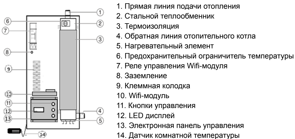
Рис. 4 Функциональные элементы котла AVL Joule AJ-W 3-9 кВт
