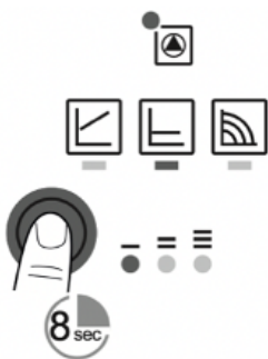
Рис. 10 Блокування та розблокування клавіш
