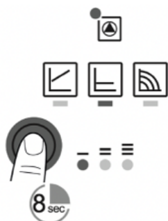
Рис. 10 Блокировка и разблокировка клавиш
