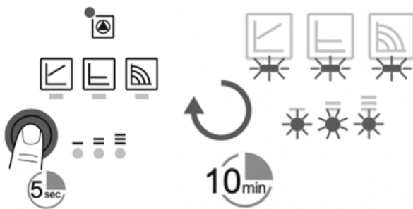
Рис. 12 Повторный пуск вручную
